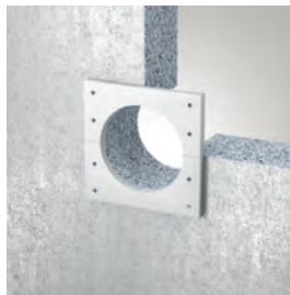
Bild 4: Aufleistung für Massivwand und leichte Trennwand (in Massivwänden wahlweise ein- oder beidseitig angeordnet)
